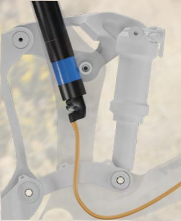
ケーブル受け部が回転することで、最大挿入長を確保してスムーズなケーブル動作を実現します。
