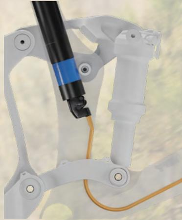
ケーブルとシートチューブが接触して、挿入長と動作に影響を与えています。
