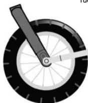
Figura 3 Utilizzare una chiave dinamometrica per serrare i dadi e i distanziali dell'asse ad una coppia di 22 NM.
