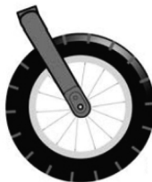
Figura 2 Insertar el eje en la horquilla
