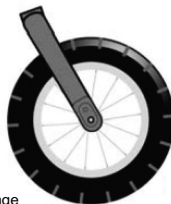
Figure 2 Insérez l'axe dans la fourche
