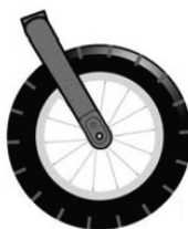
Afbeelding 2 Plaats de as in de vork
