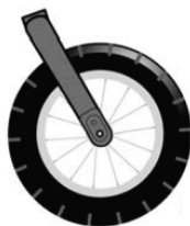
Figura 2 Inserire l'asse nella forcella
