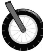
Abbildung 2 Achse in Gabel einsetzen
