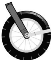
Rysunek 3 Użyj klucza dynamometrycznego do dokręcenia nakrętki osi i podkładki dystansowej z momentem obrotowym 22 Nm.
