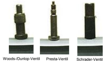
Das Schrader-Ventil (Abb. 20a) ähnelt dem Ventil eines Autoreifens. Wenn Sie einen Reifen über ein Schrader-Ventil aufpumpen möchten, nehmen Sie Ventilkappe ab und klemmen Sie das Anschlussstück der Pumpe auf dem Ende des Ventilkörpers fest. Falls Sie Luft aus einem Schrader-Ventil ablassen möchten, drücken Sie bitte den Pin am Ende des Ventilkörpers mit der Spitze eines Schlüssels oder einem anderen geeigneten Gegenstand nach unten.
