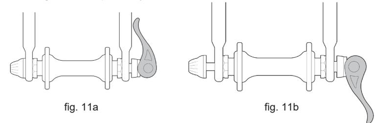
2. Si su bicicleta tiene una retención de rueda delantera con acción de leva (mecanismo de cierre rápido), mueva la palanca de la leva de la posición bloqueada o CERRADA a la posición ABIERTA (fig. 11a, fig. 11b). Posteriormente vaya al paso (4).
