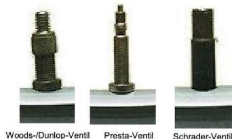
Das Schrader-Ventil (Abb. 20a) ähnelt dem Ventil eines Autoreifens. Wenn Sie einen Reifen über ein Schrader-Ventil aufpumpen möchten, nehmen Sie Ventilkappe ab und klemmen Sie das Anschlussstück der Pumpe auf dem Ende des Ventilkörpers fest. Falls Sie Luft aus einem Schrader-Ventil ablassen möchten, drücken Sie bitte den Pin am Ende des Ventilkörpers mit der Spitze eines Schlüssels oder einem anderen geeigneten Gegenstand nach unten.
