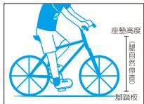
4. 騎乘者坐於座墊上，將腳踏板置於最底端，將腳自然伸直而且腳跟正好踏於腳踏板的軸心上，這就是最恰當的座墊高度。
