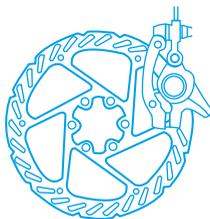
機械式碟煞=>透過煞車把手拉扯煞車線，透過煞車卡鉗的運作，使煞車來令片能夾緊碟盤，達到煞車的目的；但也由於，機械式碟煞為單邊作動，因此在調整煞車卡鉗的位置時，需將不作動邊的煞車來令片浮貼於碟盤上，雖會有些許的磨擦聲，但這樣會有最好的煞車效果。
