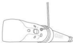
Retirer les vis de fixation de la cartouche du boîtier de fixation de la selle à l'aide d'une clé hexagonale de 2.5 mm. Sortir la cartouche.
