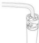
Retirer le capuchon inférieur à l'aide d'une clé hexagonale de 8 mm.
