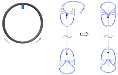
3. Avant d'ajouter l'agent d'étanchéité de pneu, gonflez le pneu jusqu'à ce que les deux talons soient positionnés sur la jante. NE PAS dépasser la pression de gonflage maximale de la jante ou du pneu. Confirmez visuellement la bonne mise en place du pneu sur la jante (la ligne de sécurité sur le pneu et au bord de la jante doit être concentrique).
