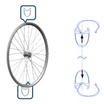
2. En commençant à l'opposé de la valve, installez l'autre talon dans le canal central de la jante, en allant en direction de la valve.
